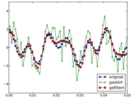
(d) gefiltertes Signal mit  $\gamma = 0.4$
