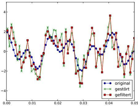
(c) gefiltertes Signal mit  $\gamma = 0.15$
