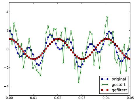
(f) gefiltertes Signal mit  $\gamma = 0.9$
