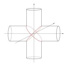
(i) Subtraktion der beiden Gleichungen liefert  $y^2=z^2$ . Also gilt für alle Punkte der Schnittmenge  $y=\pm z$ . Somit liegt die Schnittmenge der beiden Zylinder in der Vereinigung der beiden Ebenen
