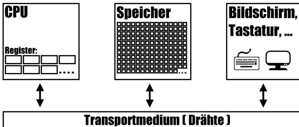
Abbildung 2: Schematischer Aufbau eines Computers
