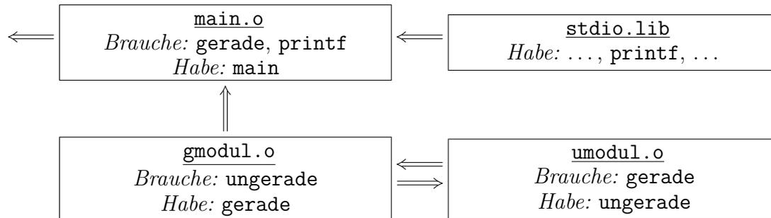
Der Linker muss eine Funktion mit Namen main finden. Diese wird vom fertig verlinkten Programm als Einstiegspunkt verwendet.
