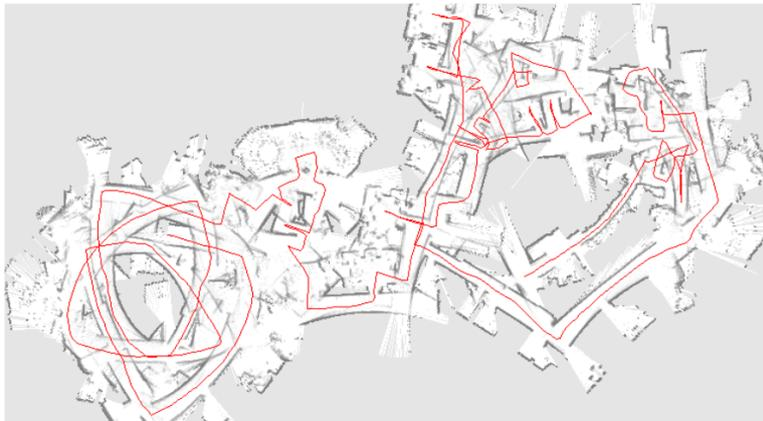
Abbildung 11: Inkonsistente Karte des Intel Research Labs, trotz hoher Partikel Zahl von 2000 Partikeln, bei ausschließlicher Verwendung eines Partikelfilters.
