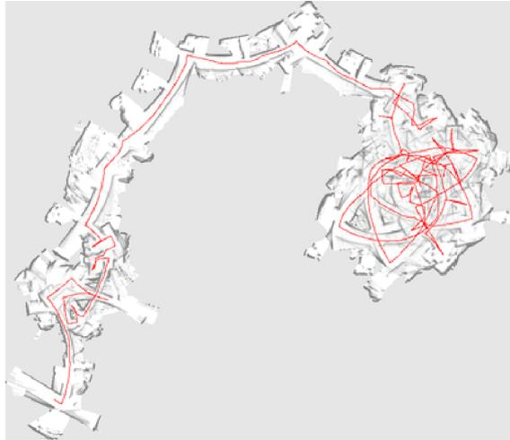
Abbildung 8: Mapping mit Positionsschätzungen, die allein auf den Odometriedaten basieren. Es ist keine sinnvolle Navigation mit der entstehenden Karte möglich. Die Trajektorie des Roboters ist in rot verzeichnet.
