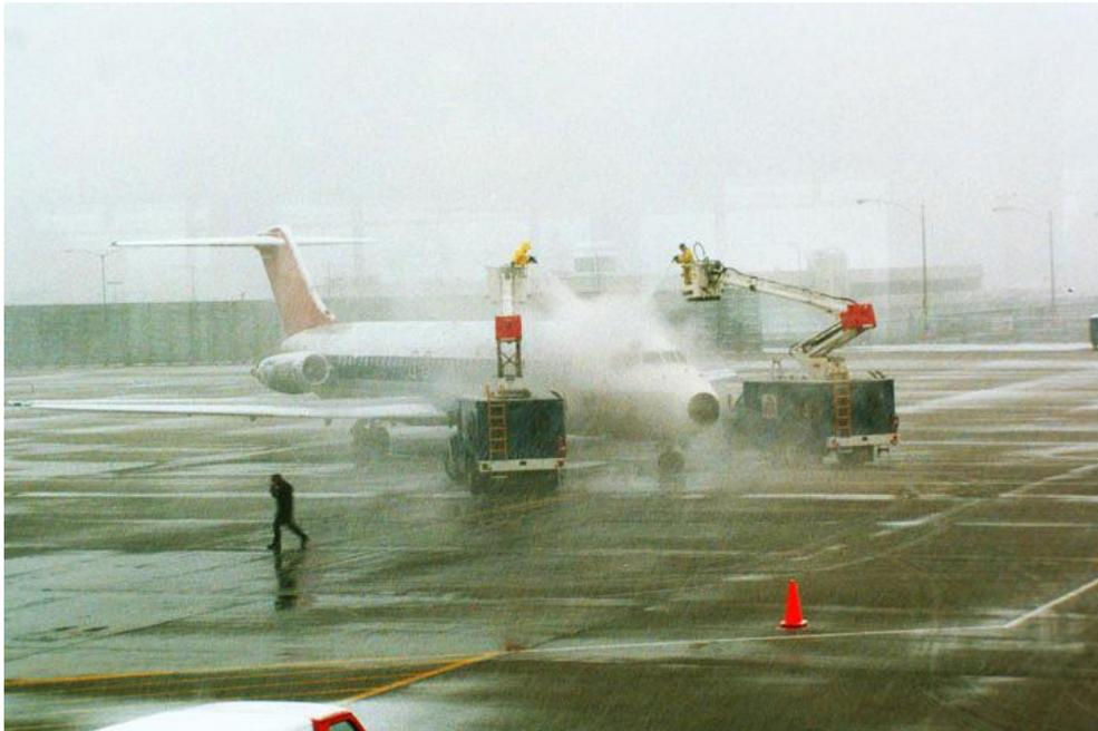
Abbildung 1.2: Enteisierung eines Flugzeuges<sup>2</sup>
