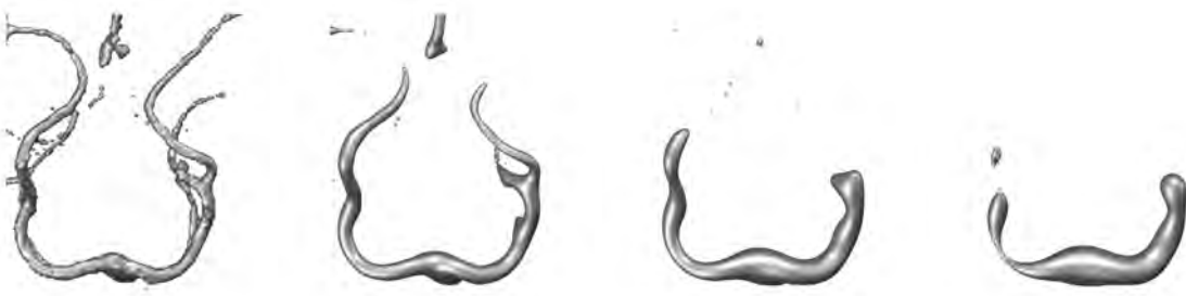
Abbildung 27: Evolution eines Testdatensatzes unter dem anisotropen mittleren Krümmungsfluss mit globaler Volumenerhaltung. Das globale Volumen bleibt zwar erhalten, akkumuliert jedoch in einem Bereich, wodurch die Strukturen durch starke Deformationen zerstört werden.
