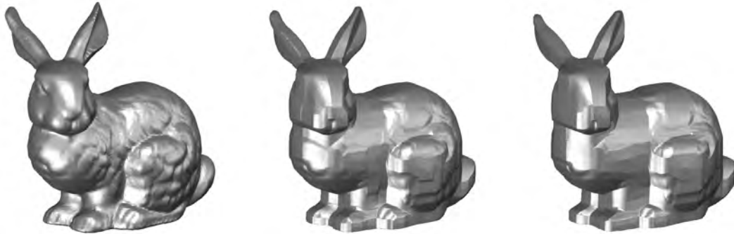
Abbildung 66: Anwendung des anisotropen mittleren Krümmungsfluss auf den Stanford Bunny [1] der Auflösung 595 \times 590 \times 462 mit einem Würfel als Wulff-Shape. Abgebildet sind Zeitschritte 0, 2000 und 4000, wobei \tau = 5.7 \cdot 10^{-8} und \lambda = 2.5 gewählt wurden.
