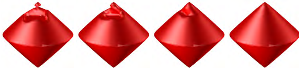
Abbildung 52: Restaurierung des Doppel-Kegels (Auflösung 65^3 ), bei dem ein Teil der Spitze künstlich zerstört wurde. Zu sehen ist die Evolution einer Niveauläche zu den Zeitschritten 0, 100, 280 und 500, wobei \tau = h^4 gewählt wurde.
