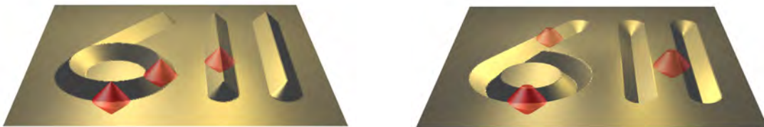
Abbildung 40: Die Restaurierung mit dem Doppel-Kegel kann Spitzen generieren, aber keine horizontalen Flächen oder Übergänge dorthin.
