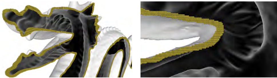
Abbildung 4: Beispiel einer Narrow-Band-Fläche: Auf einem Querschnitt durch eine Drachenfläche sind alle dort verwendeten Elemente in zwei verschiedenen Vergrößerungsstufen dargestellt. Das zugrunde liegende Vollgitter besitzt die Auflösung 982 \times 695 \times 442 .
