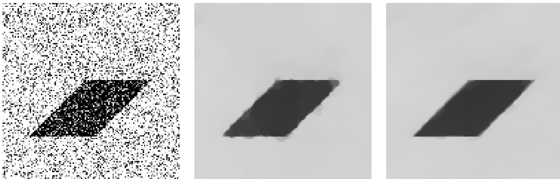
Abbildung 17: Links: Das verrauschte Ausgangsbild, ein Parallelogramm mit scharfen Ecken. Daneben Glättung mit dem isotropen ROF-Verfahren (Mitte) und mit unserem neuen Verfahren für beliebige Öffnungswinkel (rechts). Hier wurde auf zusätzliche Bregman-Iterationen verzichtet.
