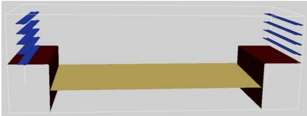
(a) Startkonfiguration: slip - Bedingungen, Anfangsgeschwindigkeit am linken sowie rechten Rand (1.0/0.0/0.0)
