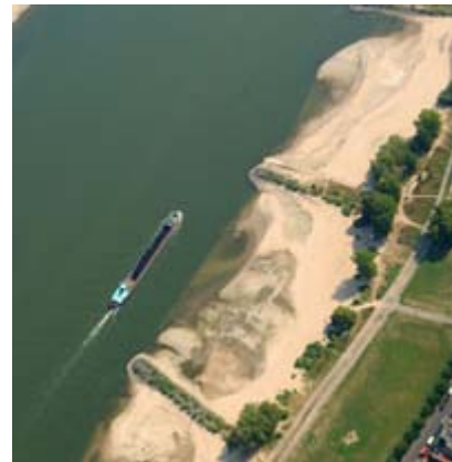
(d) Formen vor und hinter Buhnen. Aufgenommen bei Niedrigwasser des Rheins
