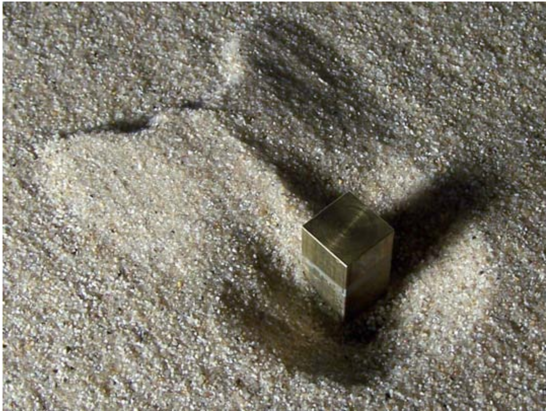
Abb. 9.23: Fluviale Hindernismarke an rechteckigen Hindernis im hydraulischen Versuchskanal der AG Herget
