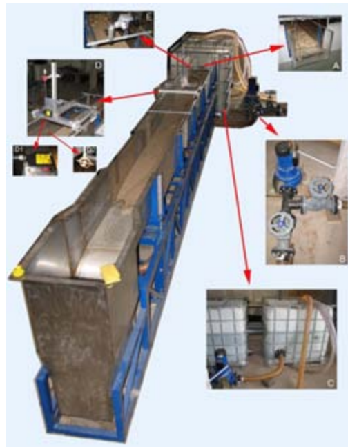
Abb. 1.2: Schematischer Aufbau des hydraulischen Versuchskanals der AG-Herget am Geographischen Institut Universität Bonn
