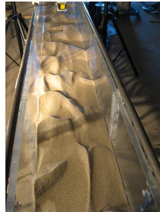
(b) Fluvial Dünen im Versuchskanal
