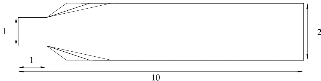
Abbildung 5.13: Geometrie des Diffusors für die erste Rechnung mit der Einströmfläche auf der linken und der Ausströmfläche auf der rechten Seite. Fett dargestellt ist die Startgeometrie, weiterhin sind die beiden Extremkonfigurationen dargestellt.
