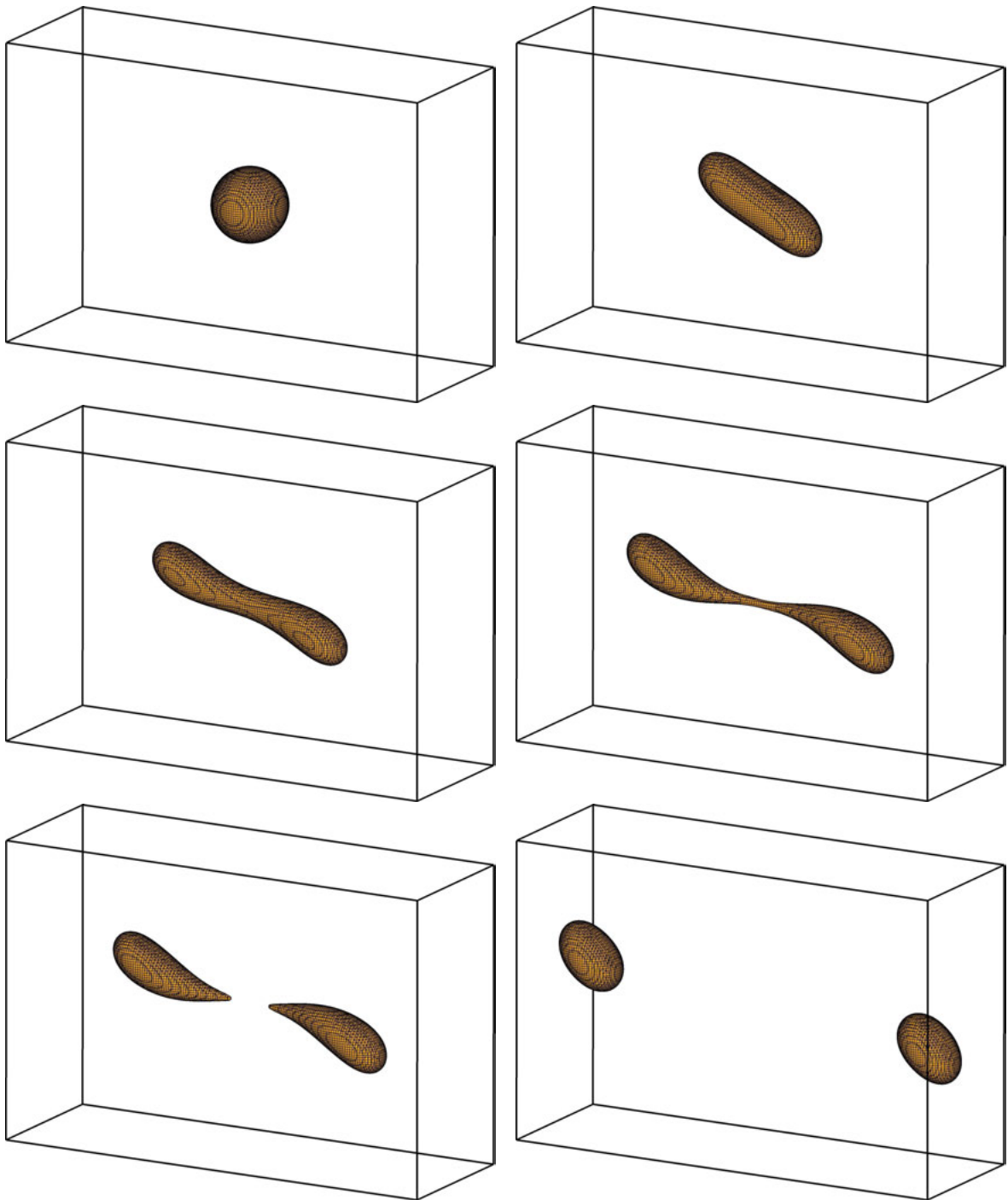
Abbildung 5.12: Instationäre Ergebnisse der Tropfendeformation in einer Scherströmung für die Parameterkonfiguration (Ca, Re) = (0.15, 15) . Zu sehen ist die zeitliche Entwicklung der freien Oberfläche zu t = 0 , t = 334.8 , t = 379.2 , t = 396.0 , t = 397.2 , t = 416.40 (oben links bis unten rechts). Das Simulationsgebiet ist (0, 3) \times (0, 1) \times (0, 2) groß und der Tropfen hat den Radius r = 0.25 . Die Gittermaschenweite ist (3/192, 1/64, 2/128) .
