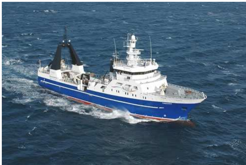
Abbildung 8.12: Das Forschungsschiff RV-Tangaroa in Fahrt. Man beachte, dass aufgrund des Wustbugs kaum Bugwellen generiert werden. Das Bild stammt aus Quelle [1].
