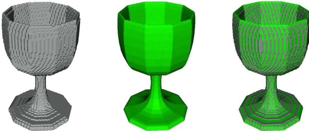
Abbildung 6.7: Vergleich der Isoflächen zum Niveauwert Null des Polygonscan-Verfahrens (linkes Bild) und der vorzeichenbehafteten Abstandsfunktion (mittleres Bild); das rechte Bild zeigt die direkte Überlagerung beider Ergebnisse.
